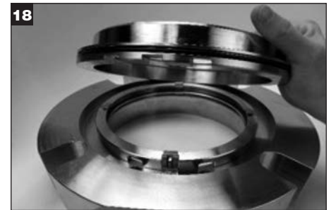
Wyjąć adapter z dławika. Wyjąć adapter o-ringa (Z) i wyrzucić. Odłożyć adapter na bok.
